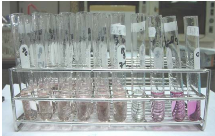
ภาพผนวกที่ 4 สารละลายตัวอย่างที่ผ่านการทดสอบปริมาณกรดยูโรนิก ตามวิธีของ Blumentkrantz and Asboe-Hansen (1973) ให้สีชมพู ก่อนนำไปวัดค่าการดูดกลืนแสง
