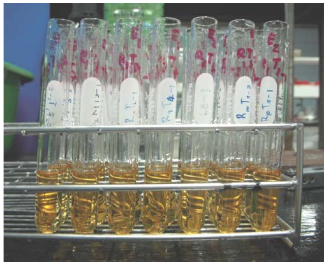
ภาพผนวกที่ 2 สารละลายตัวอย่างที่ผ่านการทดสอบปริมาณน้ำตาลโดยรวม ตามวิธี phenol-sulfuric acid assay ของ Dubois et al. (1956) ให้สีเหลือง ก่อนนำไปวัดค่าการดูดกลืนแสง
