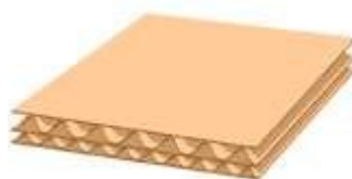
ภาพที่ 2 แผ่นกระดาษลูกฟูก 2 ชั้น (Double Wall)
