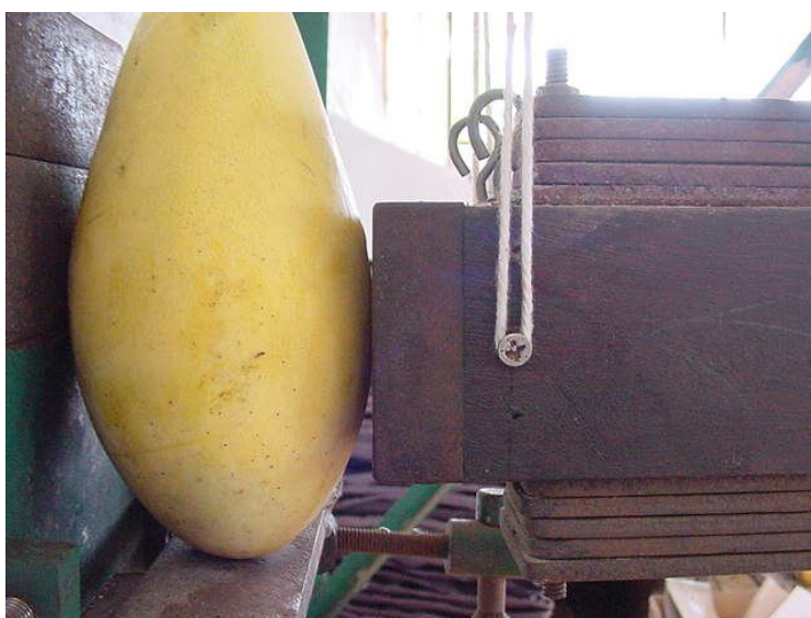
ภาพที่ 8 วางมะม่วงที่เครื่องทดสอบการกระแทก
