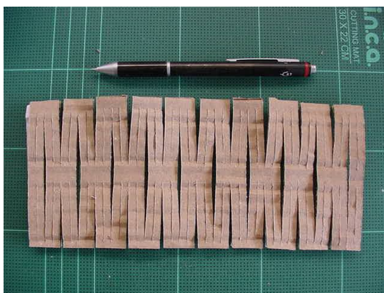
ภาพที่ 19 แผ่นกระดาษลูกฟูกสองชั้น (Double Wall) ที่ผ่านการใช้งานแล้ว
