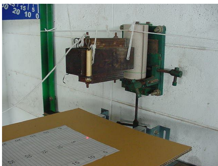
ภาพที่ 13 การกระแทกมะม่วง โดยใช้แผ่นกระดาษลูกฟูกหน้าเดียวเป็นวัสดุห่อหุ้ม(ลอนอยู่ด้านใน)
