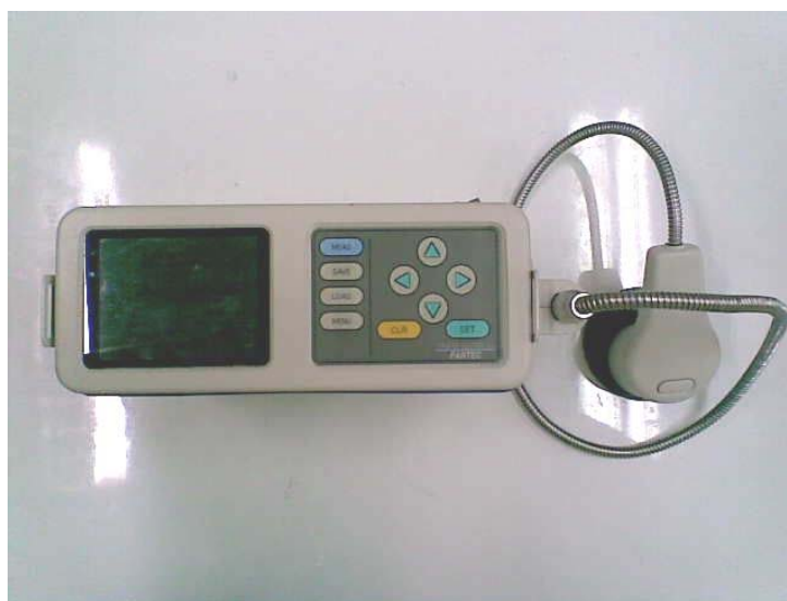
รูปที่ 3.1 แสดงเครื่องวัดเนียร์อินฟราเรดสเปกโทรสโกปี (NIR)
