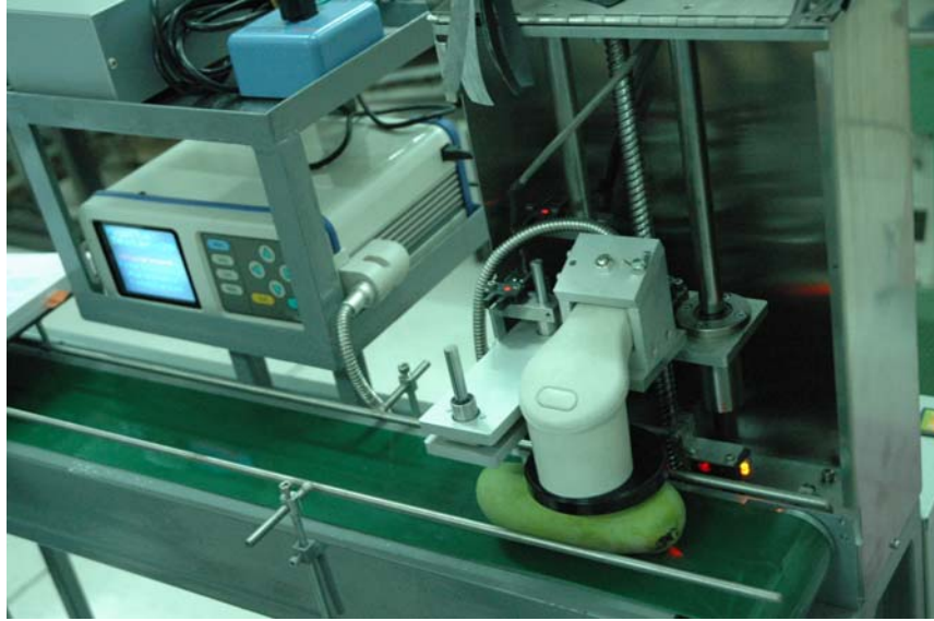
รูปที่ 3.5 แสดงการทำงานของเซนเซอร์ตรวจจับตำแหน่งมะม่วงที่จะทำการวัดคุณภาพ
