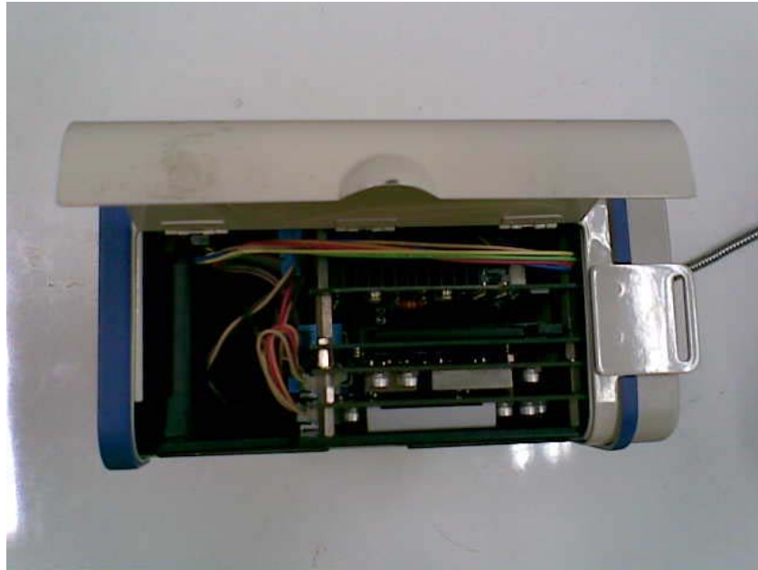
รูปที่ 5.1 ภาพถ่ายเครื่องเนียร์อินฟราเรดสเปกโทรสโกปีแบบพกพา FT20 ส่วนที่ใช้เก็บ PC-Card
