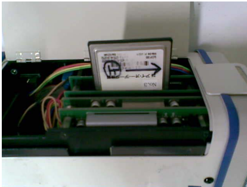
รูปที่ 5.2 ภาพถ่ายเครื่องเนียร์อินฟราเรดสเปกโทรสโกปีแบบพกพา FT20 แสดงการนำเข้า PC-Card
