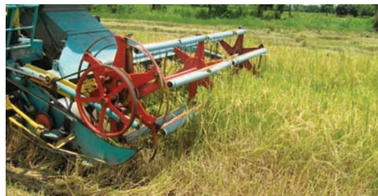
ภาพที่ 2 การทำงานของชุดหัวเกี่ยว
