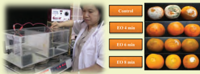
รูปที่ 4 ชุดต้นแบบผลิตน้ำอิเล็กโทรไลต์เพื่อควบคุมโรคผลเน่าของส้มเขียวหวาน
