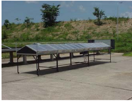
ภาพที่ 1 เครื่องอบพลังงานแสงอาทิตย์แบบอุโมงค์ที่พัฒนาขึ้น
