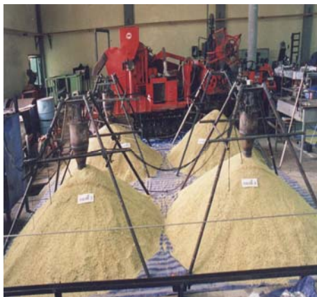
ภาพที่ 3 การทดสอบอัตราการระบายอากาศออกจากกองข้าว
