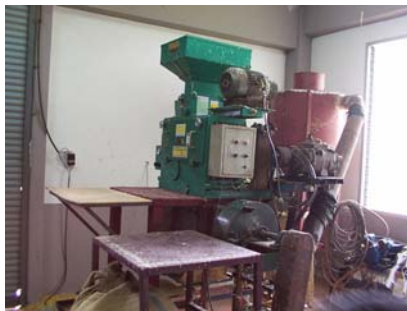
ภาพที่ 1 ชุดเครื่องกะเทาะข้าวเปลือกที่ใช้ทดสอบ
