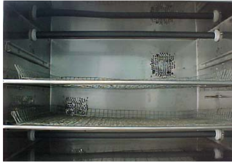
ภาพที่ 3 โครงสร้างภายใน และการติดตั้งหลอดอินฟราเรด
