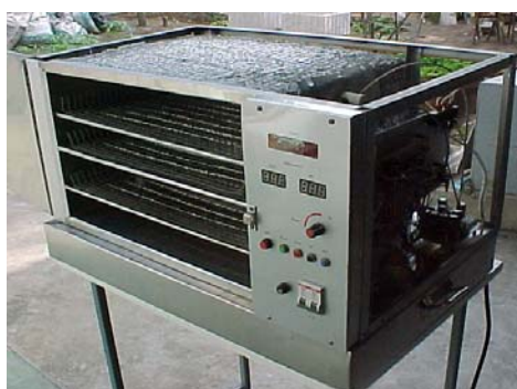
ภาพที่ 2 ตู้อบฟักถั่วลิสงด้วยเครื่องอินฟราเรดที่สร้างขึ้น
